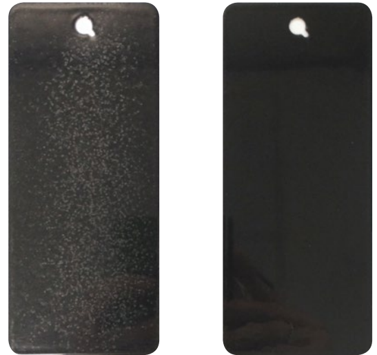
↑ Zdjęcie 3. Po lewej widoczny problem przenikania podkładu do farby nawierzchniowej, zaś po prawo widoczny rezultat P4-T1 już po optymalizacji.
